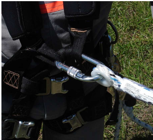
Figura 34 – Instalação do trava-quedas no cinto paraquedista
