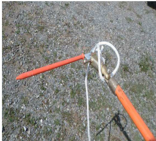
Figura 29 – Instalação do agulhão no cabeçote da vara de manobra
