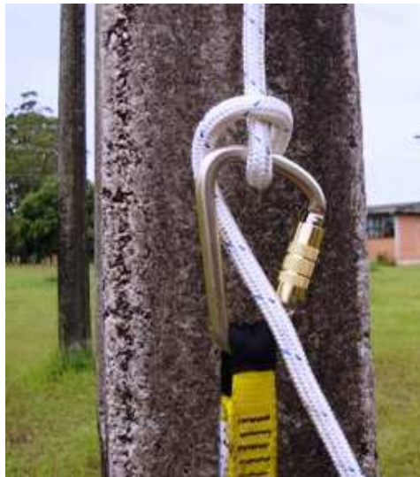
Figura 15 – Ajuste do nó de freio
