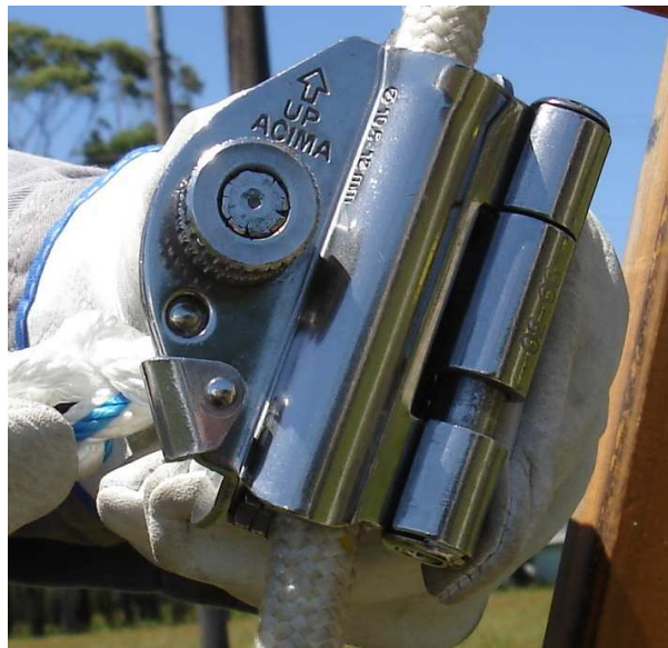
Figura 35 – Fechamento e travamento do trava-quedas
