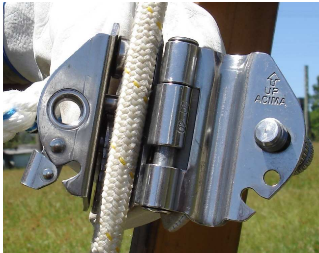
Figura 33 – Instalação do trava-quadras na linha de vida
